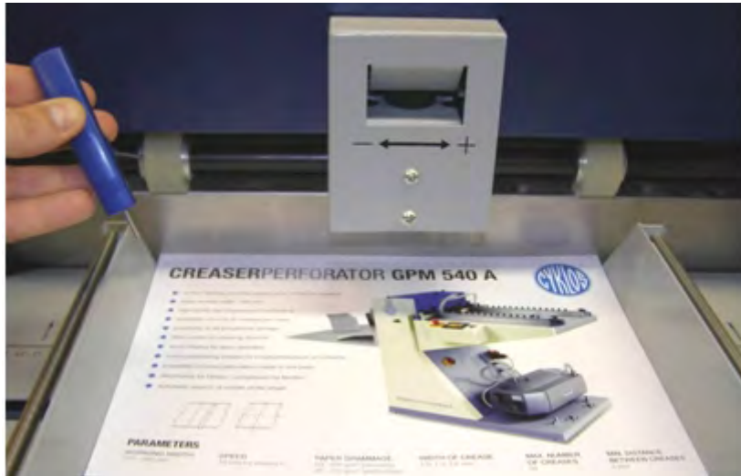
Obr. 11: Nastavení podávacích kol (pozice 29) pomocí imbusového klíče T
