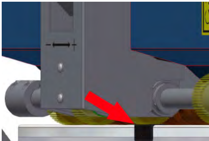
Obr. 34: Mezera mezi separátorem a podávacím kolečkem musí být v rozmezí 0,05 až 0,1 mm.
