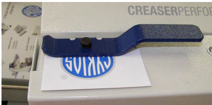
Obr. 18: Vymezení mezery frikčního podávacího systému pomocí vložení papíru pod kalipry
