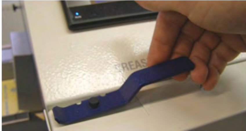
Obr. 17: Vytažení kaliprů do horní polohy
