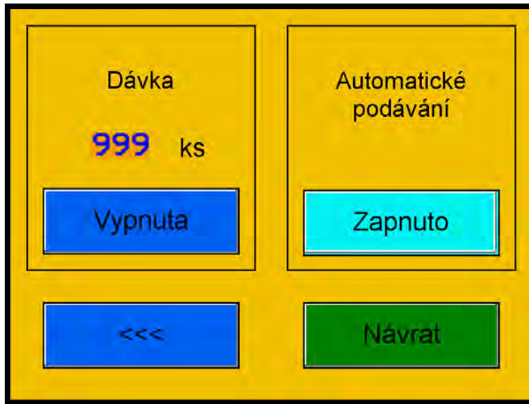
Obr. 25: Obrazovka nastavení dávky a automatického podávání.
