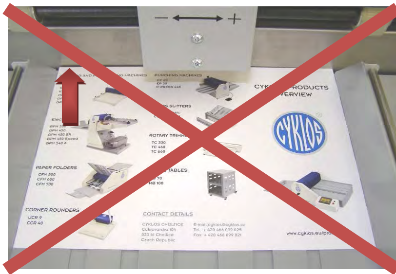
Obr. 10: Špatně připravený stůl – papír není po celé své délce dorazen k nerezovému plechu
