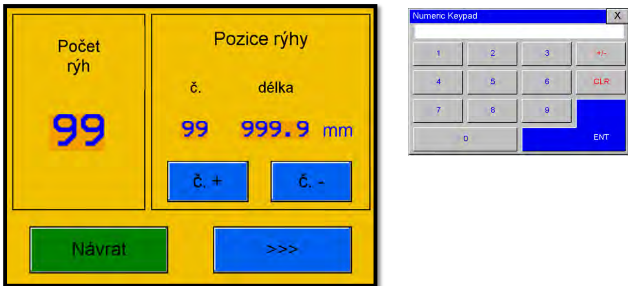
Obr. 24: Obrazovka nastavení počtu a polohy rýh pomocí numerické klávesnice
