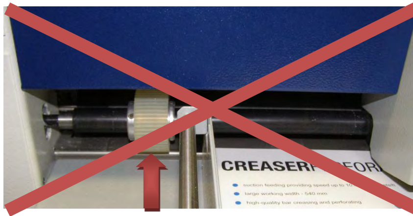
Obr. 14: Špatné nastavení podávacích kol – umístěny za příložníkem
