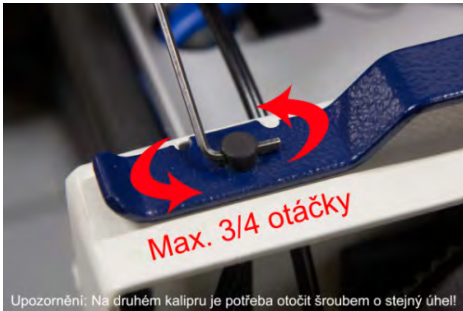
Obr. 33: Pootočením stavěcího šroubu kalpru dojde k posunu hřídele s podávacími kolečky směrem dolů a tím ke zmenšení otvoru mezi podávacím kolečkem a separátorem.
